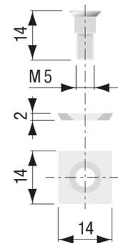
Porte outils hélicoïdal à chantourner et à calibrer à couteaux réversibles en carbure de haute qualité (HW). Cette porte outils est conçue pour le fraisage droit ou pour le calibrage sur les machines à fraiser. En option, vous pouvez utiliser un gabarit et une bague d'accélération de roulement pour réaliser des pièces courbes. Grâce aux lames en carbure de tungstène, cette fraise à rainurer coupe sans effort les planches massives, les bois durs et tendres, le MDF ou les planches laminées.
