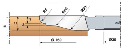
Porte outils avec des lames fixes en carbure de haute qualité (HW) pour créer de beaux profils plate-bande sur vos meubles ou panneaux de porte. Grâce aux lames en carbure de tungstène, cette fraise profilée coupe sans effort les planches ou les bois massifs. Peut également être utilisé sur du MDF. Les lames peuvent être réaffûtées mais ne sont pas remplaçables.
