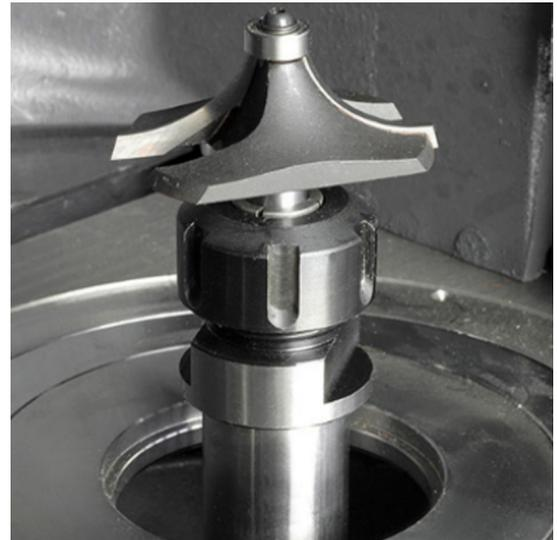
Porte-pince à queue M14 pour place sur l'arbre de votre toupie. À utiliser avec la pince de serrage T117 pour monter des défonceuses avec un diamètre de queue de 8 mm, 10 mm ou 12 mm.
