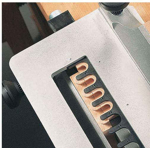
Jeu de joints à queue d'aronde pour Virutex PL11 avec fraise - pas 16mm L'ensemble comprend un moule en PVC interchangeable avec un espacement des dents (pas) de 16 mm, un douille de copiage de Ø12 mm et la fraise à queue d'aronde correcte de Ø9,5 mm. Utilisez ce jeu pour réaliser de petits assemblages en queue d'aronde (par exemple pour les boîtes à bijoux). L'épaisseur minimale du bois pour travailler correctement est de 11 mm.
