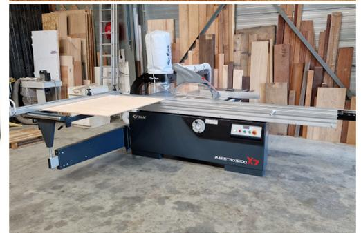
Pack promotionnel de scie à panneaux ITAMAC Maestro X7 3200mm comprenant un aspirateur, un tuyau d'extraction, des bandes de serrage et un jeu de lame de scie principale et d'inciseur pour la finition des matériaux en feuille. Scies à panneaux avec large table à rouleaux en aluminium anodisé sur double guide-barre résistant à l'usure avec rouleaux remplaçables. Équipé d'un système de démarrage / arrêt de module intégré qui garantit un confort d'utilisation optimal.
