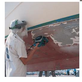
Cet abrasif de Virutex est facile à utiliser et donne des résultats rapides et efficaces sur de grandes surfaces rondes. La machine donne d'excellents résultats sur toute surface recouverte de peinture, de résine, de vernis ou de panneaux stratifiés. Facile à utiliser sur différentes surfaces telles que le bois (également contre le grain) ou les panneaux sandwich. Un manchon ponceur avec un rouleau abrasif de grain 50 est monté en standard.
