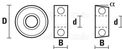
Roulement à billes supplémentaire à utiliser avec les fraises de Sistemi Klein.
