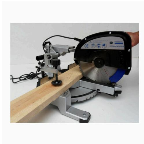
La TT255SL est une scie à onglet avec fonction de traction et la petite sœur de la TT305SLX. Équipée d'un moteur à induction silencieux de 1600 W qui ne nécessite aucun entretien (ce qui est un gros avantage par rapport au moteur à balais de carbone des modèles plus petits), elle a une fonction de traction jusqu'à 300mm, avec une hauteur de coupe jusqu'à 60mm.
