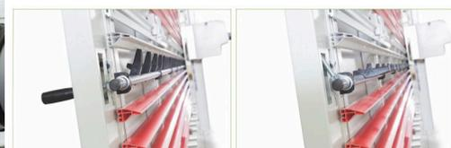
La Verticut TT2141DPM-E est une scie à panneaux verticale peu encombrante pour des panneaux de 4100 x 2100 mm.
