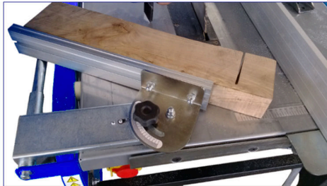
Zaaghoogte 175 mm / Hauteur de coupe 175 mm
