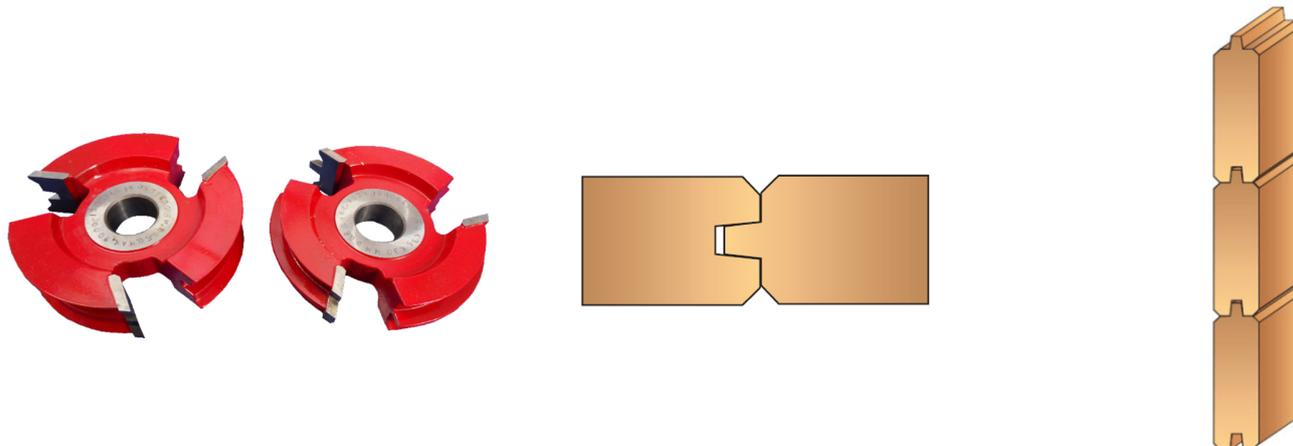
Jeu de deux fraises pour réaliser des assemblages à rainure et languette avec profil en V. Parfaitement adapté à la fabrication de planches de terrasse ou de planches pour volets ou abris de jardin, par exemple. L'épaisseur maximale du bois est comprise entre 24 mm et 28 mm. Selon que le bois est plus mince ou plus épais, le profil en V sera plus ou moins prononcé.
