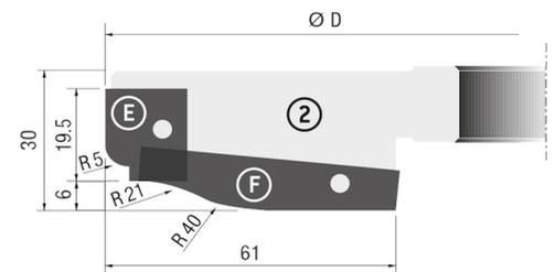
Cet ensemble se compose de deux porte outils en métal léger, équipées de couteaux en carbure de tungstène (HW). Réalisez des joints solides à l'aide de la fraise à profil/contre-profil, ou défoncez des rainures à l'aide de la fraise à plate bande. Ensemble, ces deux porte outils offrent tout ce dont vous avez besoin pour fabriquer des portes d'armoires de cuisine de haute qualité et de belle finition.
