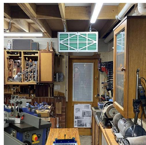
Le système de filtration d'air AC 1100 réduit efficacement la concentration des poussières dans l'air ambiant. L'appareil convient aux espaces jusqu'à 55 m<sup>2</sup>. L'air dans une pièce de cette superficie est nettoyé en moins de 6 minutes.
