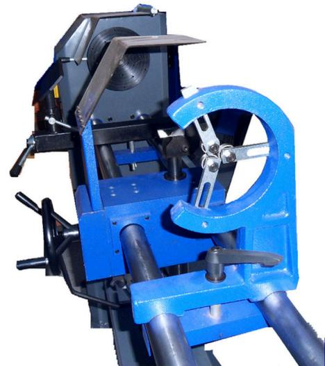
Le TT1500 est un tour à bois à usage semi-professionnel (Comfort Line), équipé d'un puissant moteur à induction d'une puissance de 1,5 cv et d'un dispositif de copie. Il a 4 vitesses (500, 1000, 1950 et 2800 rpm), qui peuvent être ajustées par courroie. Le tour à bois a un large éventail de tournage et est très stable pendant le tournage.
