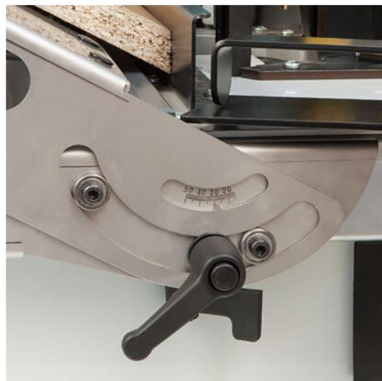
Spécialement conçu pour le collage d'onglets avec une pente de 15° à 50°. Réglage rapide et facile. Angle réglable avec échelle. Table avec 48 points de glissement pour un collage facile des bords. Avec deux poignées latérales pour un transport et une utilisation faciles. La table inclinable est une extension qui se fixe sur la plaqueuse de chants Virutex dans une table standard.
