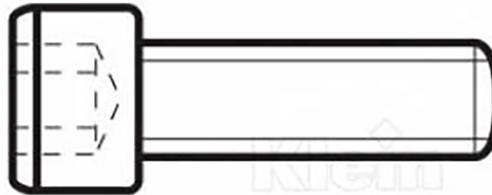
Vis de blocage tête hexagonale supplémentaire à utiliser avec les roulements pour les fraises Sistemi Klein.
