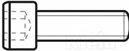
Vis de blocage tête hexagonale supplémentaire à utiliser avec les roulements pour les fraises Sistemi Klein.
