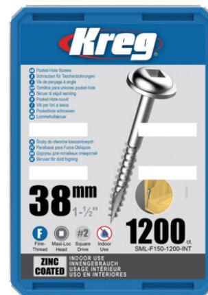
Vis à trou de poche Kreg à entraînement carré. La vis a une longueur de 38 mm (1 1/2") et un filet fin, ce qui la rend idéale pour le bois dur, et est fabriquée en zinc. Le zinc offre une protection suffisante contre la rouille et constitue une alternative abordable aux variantes Blue-Kote et en acier inoxydable.
