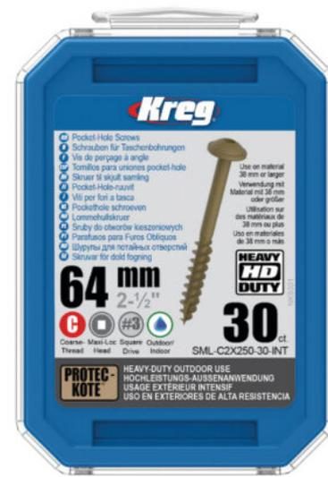
Les vis Kreg HD sont destinées à être utilisées avec le gabarit Kreg HD et avec des matériaux de 38 mm ou plus d'épaisseur. Ces vis de 64 mm de long en acier trempé ont une incroyable résistance à la déchirure. Grâce à la finition Protec-Kote à trois couches anticorrosion, ils ont un effet antifongique durable. A visser avec un tournevis carré de taille 3.
